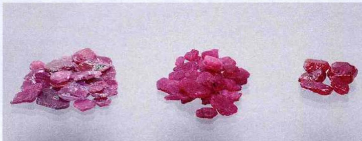
Cristaux de rubis plats provenant de Montepuez au Mozambique. Non chauffés avant le traitement (à gauche), chauffés en présence de borax (au milieu) et chauffés avec remplissage des fissures par du verre au plomb (à droite).
