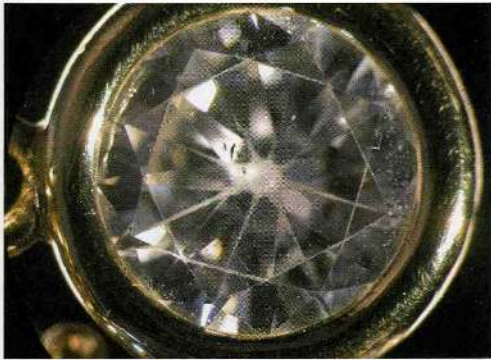
Figur 2: Die weissliche Kantenabrasion ist von vorne leicht erkennbar.
