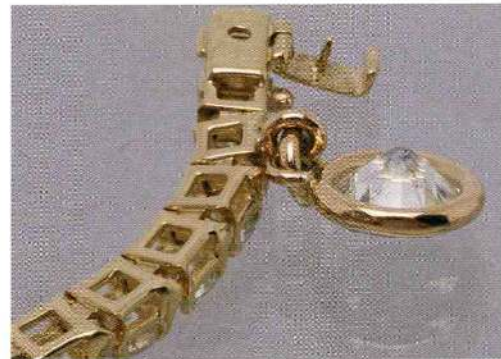
Figur 4: Die Fassung des Diamanten ist un- genügend. Der Pavillon liegt frei exponiert und ist deshalb stark be- schädigt.
