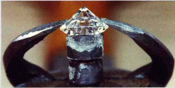
一顆明亮型圓鑽在模具上完成底層面拋光。(Photo / A. Guichon)
