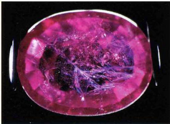
圖一 鉛玻璃填充紅寶常有著氣泡和紫藍色閃光。 由於是低溫的處理，鈦針狀物將是完整的。 (照片提供H. A Hänni, SSEF)
