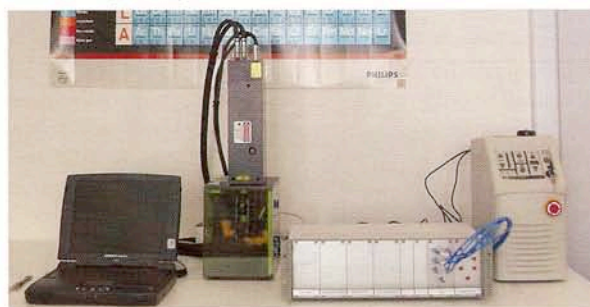
Figure 1 : Le SSEF GemLIBS™ au laboratoire de la SSEF Swiss Gemmological Institute. L'instrument est constitué d'un compartiment d'analyse surmonté du Laser (au centre), sept spectromètres à haute résolution et leur fibres optiques, l'alimentation électrique du Laser (à droite) et un ordinateur pour contrôler les paramètres d'analyse (à gauche).
