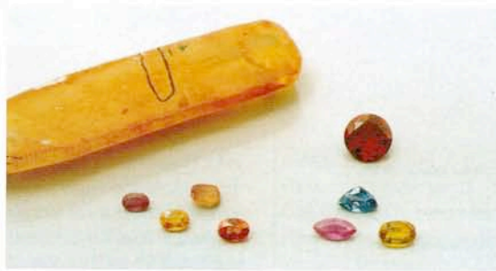
Figure 2 : Une partie des échantillons analysés par LIBS. Les pierres taillées à gauche sont traitées par diffusion de béryllium. Les pierres à droite sont naturelles et chauffées traditionnellement, le rubis rond est synthétique (pas de béryllium). Au fond un saphir jaune synthétique (méthode Verneuil) dopé par 2 – 3 ppm béryllium. © M.S. Krzemnicki, SSEF 2004.
