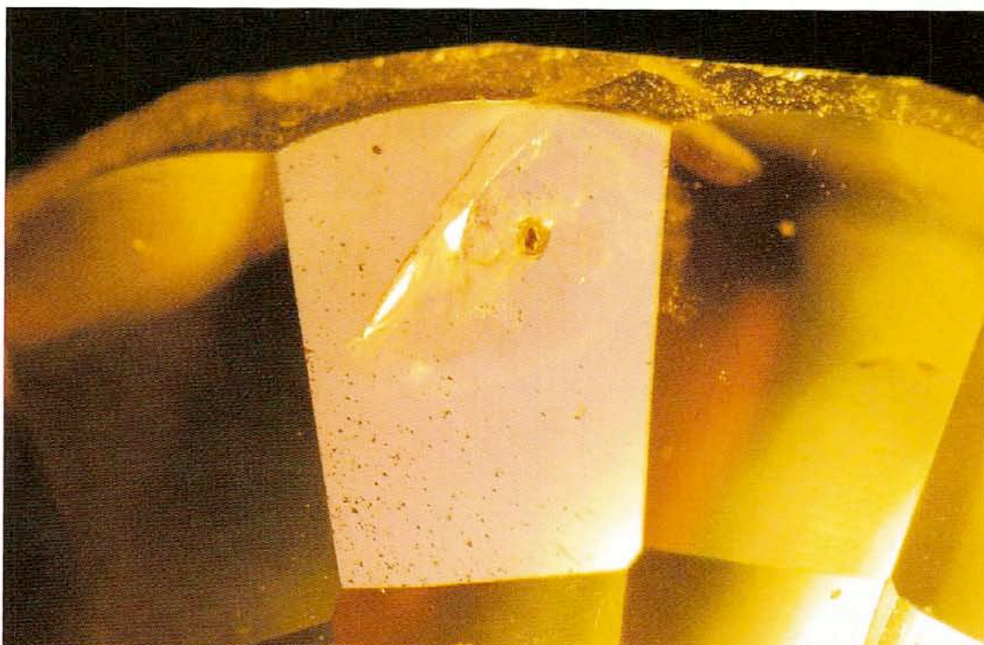
Abb. 5 Brennfleck auf einem orangefarbenen Saphir. Durch sorgfältige Einstellung des Geräts kann die Beschädigung klein gehalten und die Position unauffällig gewählt werden. Die Vertiefung liegt über einem Einschluss und hat einen Durchmesser 0.1 mm .
