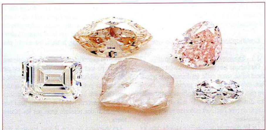
Fig. 1 : Les diamants bruts (9,03 ct) de type II sont souvent grands et plats. C'est pourquoi une fois taillés, leur forme est fantaisie : navette (5,83 ct), oval (1,61 ct), rectangulaire pans coupés (8,19 ct), coeur (5,18 ct), etc.
