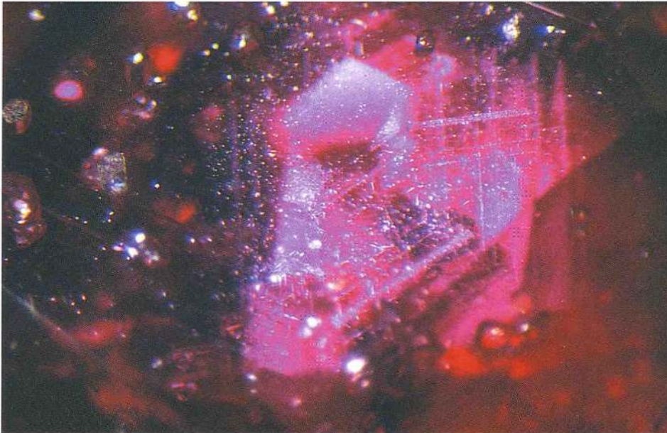
Abb. 6 Einschlussbild eines nicht erhitzten Rubins aus der "Charlyne Mine" mit Rutilseide, Apatitkristallen und bislang noch nicht näher identifizierte Erzminerale. Bildbreite 4 mm.
