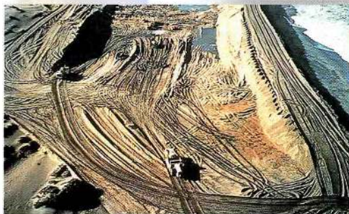
Diamantförderung an der Küste Namibias, wo rund 30 m Sand abgeräumt werden müssen, um an die steinige Oberfläche zu gelangen. Dort liegen an sekundärer Lagerstätte die Diamantkristalle in ehemaligen Bachbetten. (Bild: De Beers)
