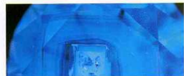
Die Wachstumsgeschichte eines Diamantkristalls, sichtbar gemacht mit Kathodolumineszenz, an einem 1-karätigen Brillanten. (Bild: H. A. Hännli)
