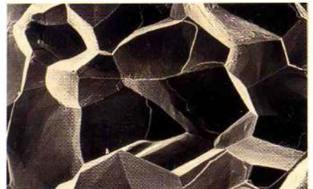
Figure 7 : Prise de vue au microscope à balayage (MEB) de la surface d'une cassure d'hessonite. La structure granuleuse et polycristalline est facilement reconnaissable. Cette pierre brute jaune provient d'Afrique de l'Est. Longueur du trait noir 0,1 mm. (Photo © REM Labor, Université de Bâle.)
