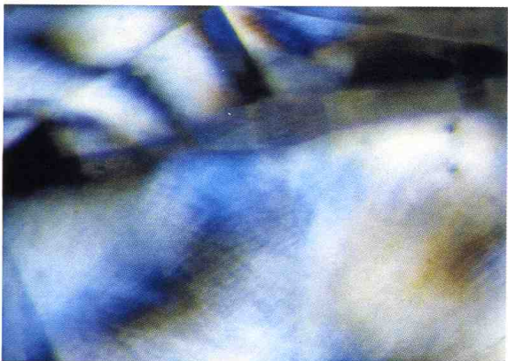
Figure 3 : Tensions internes dans un diamant traité GE POL observé entre polariseurs croisés. Les vives couleurs de polarisation, révèlent les fortes tensions internes présentes dans ce diamant GE POL. On note également l'absence de contraintes internes autour des inclusions. © SSEF Swiss Gemmological Institute
