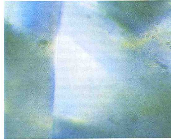
Figure 2 : Inclusion cernée d'un atoll dans un diamant traité GE POL. Observation au microscope binoculaire en éclairage fond noir. Grossissement x60. La forme particulière de cet atoll suggère fortement que le diamant a été traité à haute température et haute pression, dans le domaine de stabilité du diamant. © SSEF Swiss Gemmological Institute
