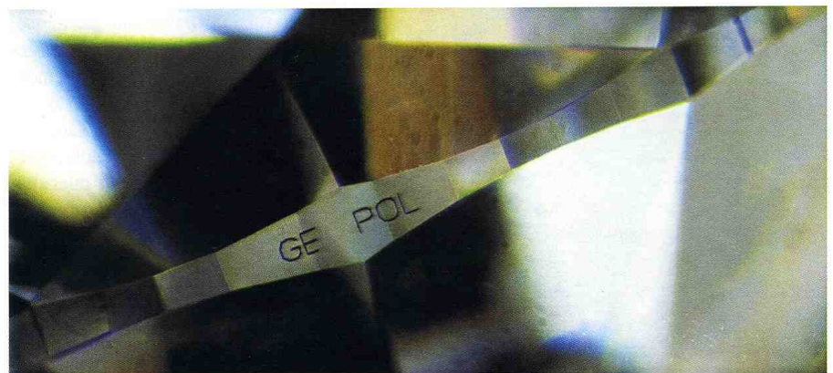
Figure 1 : Inscription GE POL sur le rondiste d'un diamant traité. Le rondiste facetté de ce diamant traité et incolore (couleur E) porte la mention GE POL. Cette inscription gravée au laser indique les initiales de la compagnie américaine General Electric qui effectue le traitement et de la compagnie anversoise Pegasus Overseas Limited qui commercialise les pierres. © SSEF Swiss Gemmological Institute
