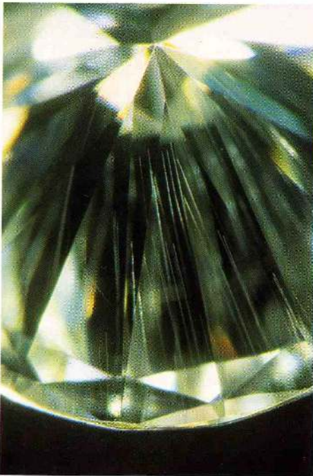
Abb. 2 Charakteristisches Einschlussbild in synthetischem Moissanit. Die feinen, parallelen Hohlkanäle verlaufen praktisch immer senkrecht zur Tafel.
