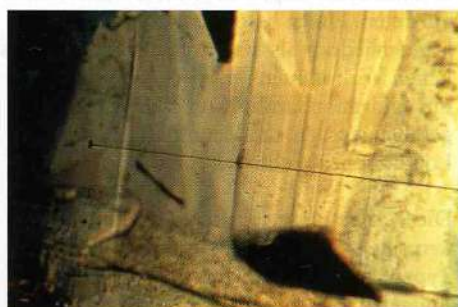
Abb. 28: Kleiner gerundeter Apatitkristall mit einer Röhre, die sich senkrecht zu einer prismatischen Wachstumsfläche in einem Saphir vom Typ II aus Madagaskar entwickelt hat. – Immersion, 50 \times .
