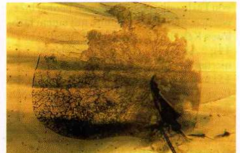
Abb. 26: Dendritische Substanz auf Heilungsriß in einem hitzebehandelten Saphir aus Madagaskar. – Immersion, 40×.
