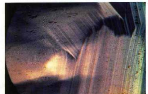
Abb. 19: Saphir vom Typ I aus Madagaskar mit Farbzonierung parallel zu den Flächen n, r und n'. Blickrichtung etwa 30° zur c-Achse geneigt. – Immersion, 50×.
