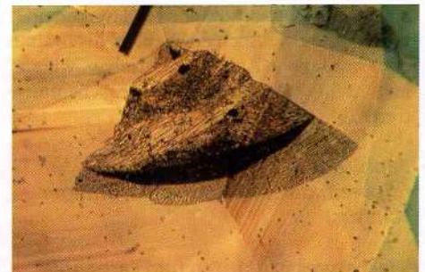
Abb. 25: Heilungsriß in einem Saphir aus Madagaskar. – Immersion, 50×.
