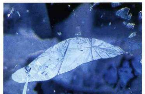
Abb. 31: Drei-Phasen-Einschluß in einem Saphir vom Typ III aus Madagaskar mit einer Orientierung parallel zur Basis. Das Bild zeigt eine flüssige und eine gasförmige \text{CO}_2 -Phase sowie Diaspornadeln. Blickrichtung parallel zur c -Achse. – 50 \times .
