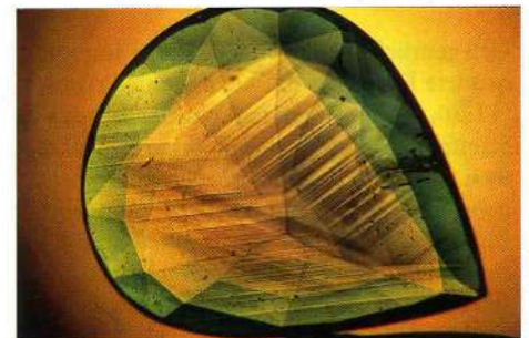
Abb. 18: Saphir vom Typ I aus Madagaskar mit Farbzonierung parallel zum Rhomboeder r und zur Dipyramide n. Blickrichtung etwa 30° zur c-Achse geneigt. – Immersion, 30×.
