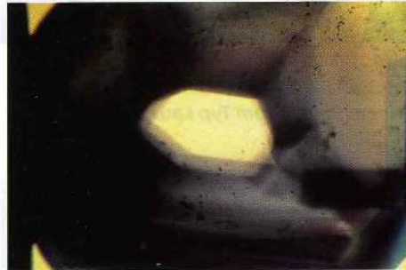
Abb. 14: Saphir vom Typ I aus Madagaskar mit beinahe farblosem Kern und blauem Rand. Blick fast parallel zur c-Achse. Immersion, 30×.
