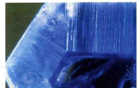
Abb. 12: Prismatischer Saphir aus SSE Madagaskar mit dunkelblauem Kern und heller blauem Rand. Der Rand zeigt eine weiße Streifung auf den Basisflächen, die senkrecht zum prismatischen Wachstum orientiert ist. Blick parallel zur c -Achse. – 4×.
