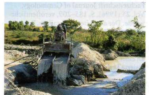
Abb. 6: Der Schotter mit den Saphiren wird mittels einer Rüttelmaschine im Arbeitsgebiet der Firmen Multicolour und Ste. Arc-en-Ciel Gem.-Corp. bearbeitet.
