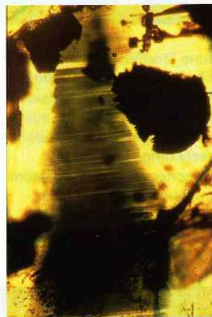
Abb. 15: Saphir vom Typ I aus Madagaskar mit dunkelblauem Kern und beinahe farblosem Rand. Die Zonierung des blauen Bereichs verläuft parallel zur Basis. Blick senkrecht zur c-Achse, die c-Achse verläuft vertikal. – Immersion, 40×.
