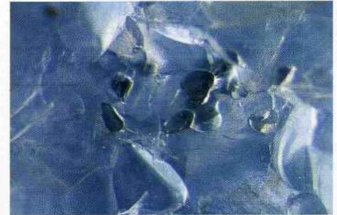
Abb. 24: Spinelleinschlüsse auf einer Oberfläche eines Saphirs vom Typ I aus Madagaskar. – 30×.
