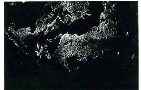
Abb. 2 Smaragd mit ölbehandelten Rissen. Das leichtflüchtige Öl trocknet langsam aus, und Luft dringt in die Risse, was an den hellen, teilweise lappigen Strukturen erkennbar ist.
