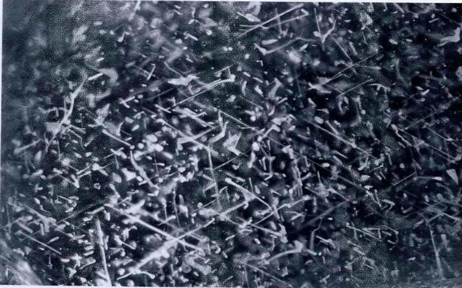
Abb. 7. Nadeln und dünne Plättchen von Hämatit, die im Durchlicht eine braune Färbung zeigen; das regelmäßige Muster entspricht der Anordnung der Rutil-, „Seide“. –  $\times 40$
