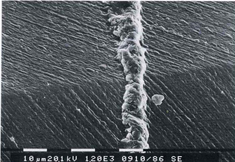
Abb. 6. Facettenkante, über die ein gefüllter RiB läuft. Man erkennt die polykristalline Beschaffenheit der Füllung, die leicht hervorsteht. – REM-Aufnahme, die Länge des weißen Balkens entspricht 10 μm.
