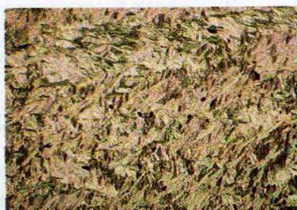
Abb. 4: Dünnschliff vom Biotitschiefer, zwischen gekreuzten Polarisationsfiltern. Erkennbar sind Biotit (bunt) und Erzkörner (schwarz).
