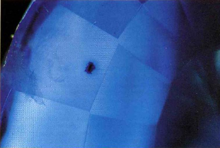
Abb. 6: Verstärkt gefärbte Verletzung (vergrößerte Oberfläche) im Unterteil eines blauen Diffusionskorundes. Diese Farbkonzentration läuft seitlich rasch aus.
