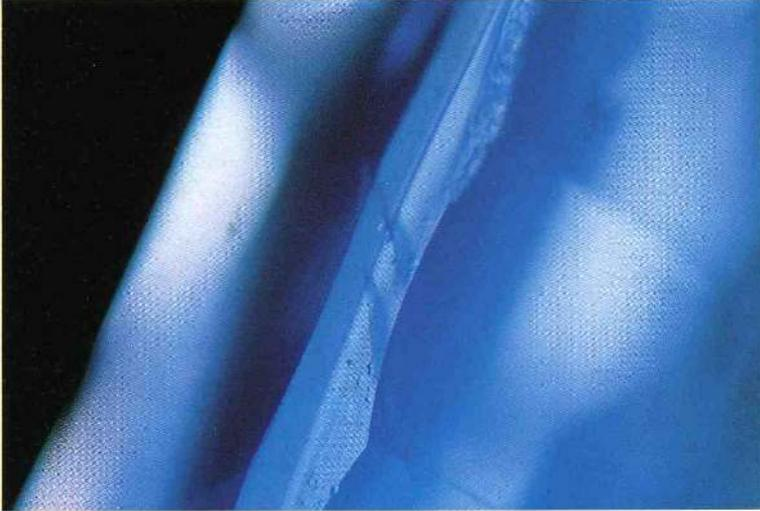
Abb. 4: Angeschmorte Oberfläche an der Rundiste eines diffusionsbehandelten Korundes. Der Stein zeigt an den zwei Rißchen typische Farbkonzentrationen.
