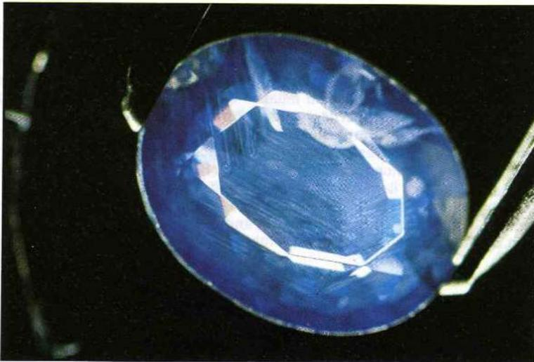
Abb. 1: Spannungsrisse und dunkler Ring an der Rundiste eines diffusionsbehandelten blauen Korundes. Die faserartigen Einschlüsse folgen ungefähr den Wachstumszonen.
