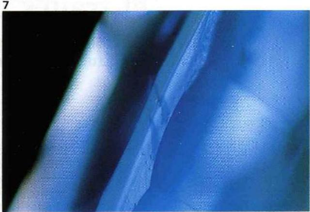
▲ *Diffusionsbehandelter Korund mit zwei Risschen an der Rundiste, die verstärkt gefärbt sind.*
