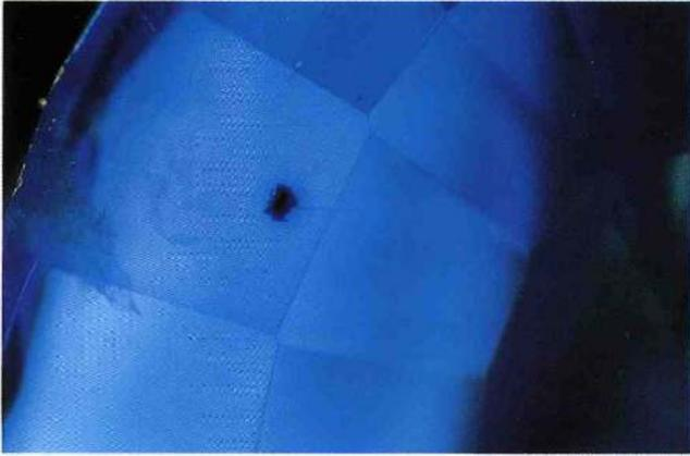
◀ *Verstärkt gefärbte Verletzung (vergrößerte Oberfläche) im Unterteil eines blauen Diffusionskorundes. Diese Farbkonzentration läuft seitlich rasch aus.*
