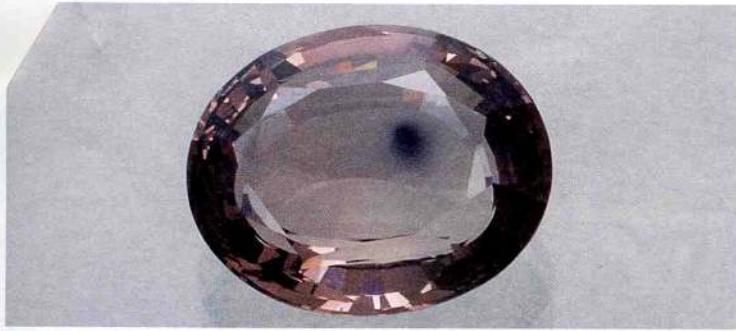
Figure 3: Ce changement de couleur réversible possède un état intermédiaire de couleur brune quand la couleur retourne dans son état original jaune clair. Le point noir sur la photo est dû au laser de la microsonde Raman.
