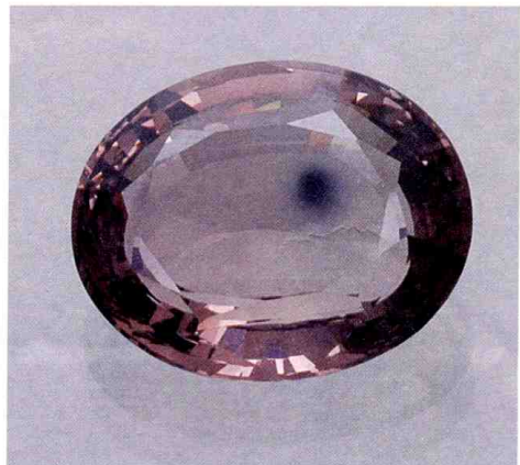
Abbildung 3: Bräunliches Zwischenstadium des photochromatischen Glases beim Übergang zurück in die hellgelbe Ursprungsfarbe. Rechts im Stein ist ein dunkler blaugrauer Fleck erkennbar, hervorgerufen durch den intensiven Laserstrahl des Raman-Mikrospektrometers.
