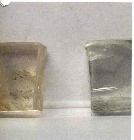
Figure 3: Deux morceaux d'un diamant synthétique CVD. A gauche: le diamant synthétique non traité est brun, pour référence. A droite: après traitement à Haute Pression et Haute Température, le diamant synthétique est incolore.
