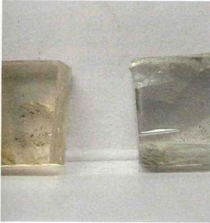
Abbildung 3: Zwei CVD-synthetische Diamanten (ungeschliffen). Die bräunliche Probe links ist noch unbehandelt, während der farblose CVD-synthetische Diamant rechts nachträglich noch mit einer HPHT-Behandlung entfärbt wurde.
