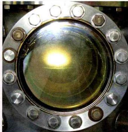
Abbildung 1: Mikrowellenkammer des Labors für Ingenieurtechnik von Hochdruck-Materialien in Paris (Frankreich). Hinter einer dicken Quarzscheibe erkennt man das ionisierte Gasgemisch (Plasma).
