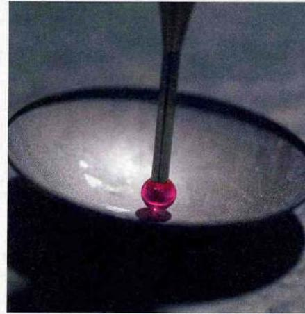
Abbildung 4: Diese Schale aus polykristallinem CVD-synthetischem Diamant wird serienmässig im High-end-Audiosystem 800 von Bowers & Wilkins eingebaut. Das Foto zeigt wie die Dicke des Präparats getestet wird. Der Durchmesser der Schale beträgt exakt 26,29 mm. Quelle: Bowers & Wilkins <http://www.bowers-wilkins.de/>
